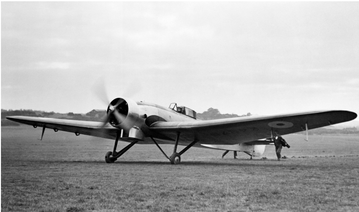
Bristol High Altitude Monoplane 138. Construction en bois, cockpit chauffé Moteur : Pegasus de 500 cv. Envergure : 20.12 m, longueur 13.41 m, hauteur 3.12 m. Surface alaire 52,77 m 2 . Vitesse maxi : 285 km/h à 45 000 pieds.
